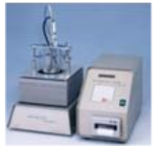
屋根防水アスファルト軟化点の測定装置(JIS K 2207)
