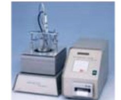
屋根防水アスファルト 軟化点の測定装置 (JIS K 2207)
